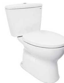
CS300DRT3 Bàn cầu hai khối, nắp đóng êm Hệ thống xả Siphon 4.8/3L Thiết kế: Thân dài Tâm xả: 305mm Phụ kiện bao gồm van dùng, Dây cấp nước 755D x 350W x 760H mm
