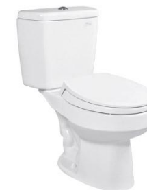
CS660DT1Y1 Bàn cầu hai khối, nắp đóng êm Hệ thống xả Siphon 6/3L Thiết kế: Thân tròn Tâm xả: 305mm Phụ kiện không bao gồm van dùng Giống đế 670D x 420W x 745H mm
