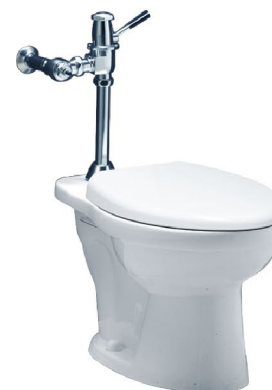
CP1333 + BF443 Bàn cầu xả gạt tay Hệ thống xả thẳng : 6 lít Dùng với bộ xả BF443 Áp lực nước : 1~4kgf/cm 2 Tâm thoát phân : 300 mm 660x375x370mm CP1333 : 1.628.000đ BF443 : 2.321.000đ
